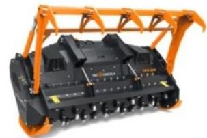
Rotor s vyměnitelnými hřídelemi, s pevnými kladivy, která jsou umístěna ve šroubovici.
